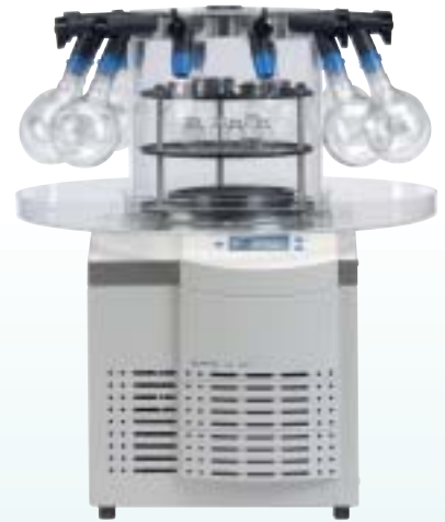
プロセスB LDplusコントローラ 3段ラック 265mm、棚間隔79mm 75mmシャーレ 8枚/段 真空バルブ12ポート 真空ポンプ内蔵タイプではありません。
