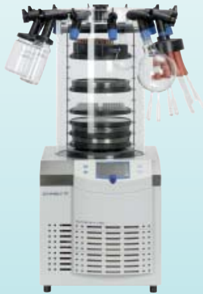
プロセスB LSCコントローラ 加熱棚10段ラック 200mm、棚間隔25mm 75mmシャーレ 5枚/段 真空バルブ12ポート アンプル瓶 15本/個 真空ポンプ内蔵タイプではありません。
