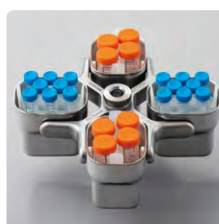
SF-724ロータ 15mLコニカル管×16 50mLコニカル管×8
