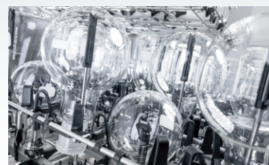
ノズルにフラスコをセットした状態
