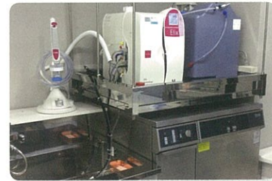
純水装置 / 洗浄機 ● Elix Advantage 10, 100L tank, 特注吊棚 ● G7883CD
