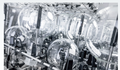
ノズルにフラスコをセットした状態
